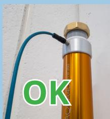
Faites attention à l'orientation du connecteur. Laissez de l'espace libre et positionnez-le correctement **avant** de le serrer.
