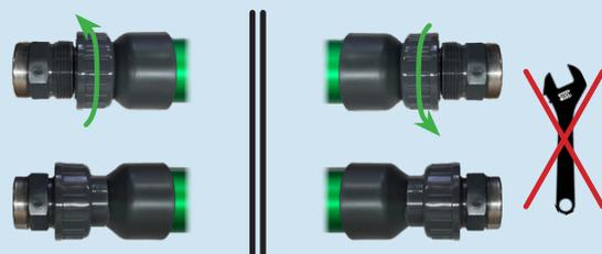
Atornillar a mano el TU de los adaptadores. No utilice herramientas, ajuste a mano solamente. La flecha de la TU debe apuntar en la dirección del flujo de agua.
