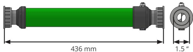
La Unidad de Tratamiento TU H-A 60 transmite al agua las señales generadas por la Unidad de Control CU H 00. Este modelo puede manejar caudales de agua de hasta 3,6 m<sup>3</sup>/h (15,8 US gpm).
