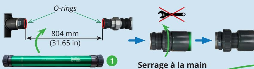
Visser l'unité de traitement (TU) à la main. Ne pas utiliser d'outils. La flèche doit pointer dans le sens d'écoulement de l'eau.
