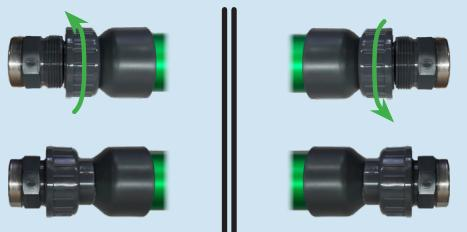
Atornillar a mano el TU de los adaptadores. No utilice herramientas, ajuste a mano solamente. La flecha de la TU debe apuntar en la dirección del flujo de agua.
