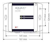
Die Steuerungseinheit CU H 00 ist das Gehirn des Systems, sie überträgt Signale an die Behandlungseinheit (TU) und überwacht ständig den präzisen Betrieb des Systems.
