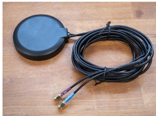
Connectez l'antenne aux 2 connecteurs de l'unité de contrôle. Choisissez un bon emplacement pour l'antenne, de préférence en hauteur et à l'écart des grosses pièces métalliques qui pourraient masquer le signal. Fixez les câbles pour éviter toute traction accidentelle.
