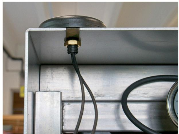
*Antenne montée dans son socle*
