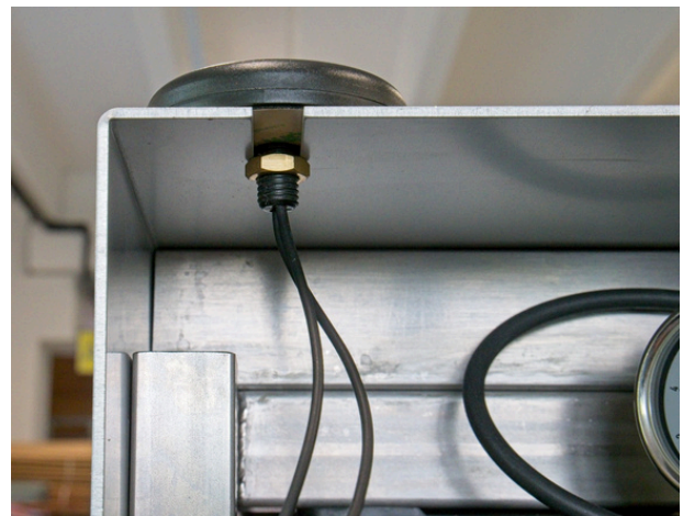
Antena montada en su zócalo
